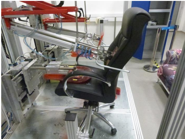
Res.3/Pic.3: Oturak Arkalık Dayanıklılık Testi Seat Back Durability Test
